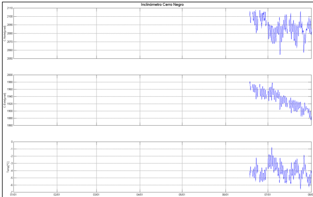
Figura 66. Componentes de inclinación Norte y Este, temperatura del inclinómetro electrónico Cerro Negro, instalado en el volcán del mismo nombre, para el periodo comprendido entre el 1 de enero de 2015 y el 31 de julio de 2015.
