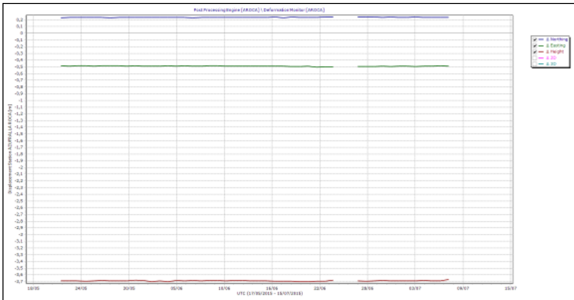
Figura 86. Variaciones en las direcciones Norte, Este y Altura de la estación GNSS Roca instalado en Azufral, para el periodo comprendido entre el mes de mayo de 2015 y el 7 de julio de 2015.
